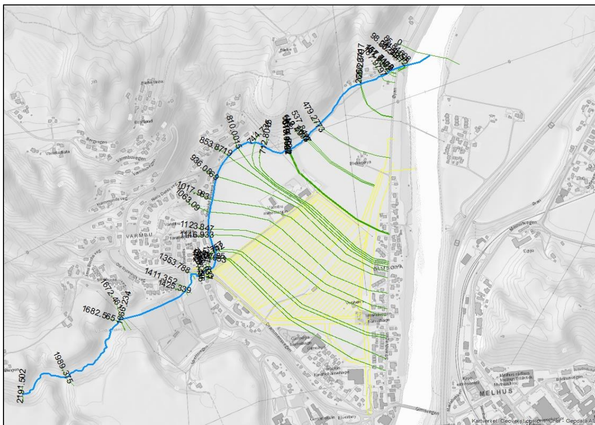
Figur 12 Elvemodellens utstrekning med modellerte tverrprofil med nummerering (grønne linjer) og senterlinje på elven (blå linje). Skisse av planområde med omlegging av fylkesvei 6606 fra Strandvegen og ny fylkesvei 6604 i Drammens-/Varmbuvegen er vist i gult.
